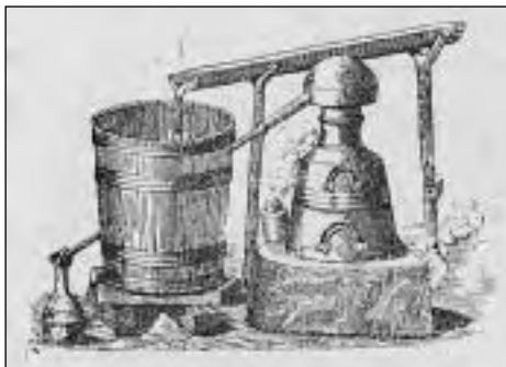
Destylacja olejku różanego w Bułgarii. Ilustracja z książki „Olejki eteryczne” Henryka Ruebenbauera. Wyd. Fr. Heroda.
